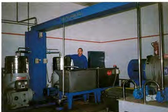
Máquina que recibe el aceite con impurezas, efectuando en sus pilas de decantación, por circuito cerrado, la separación y el filtraje.
