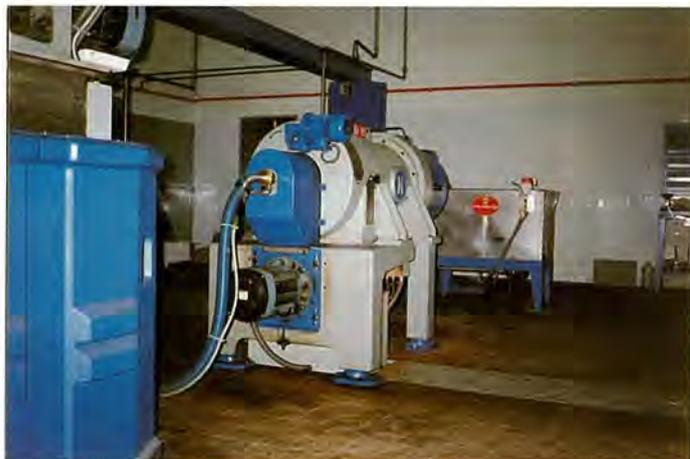
Máquina que absorbe la aceituna triturada junto con agua caliente, por sistema centrifugado, separando el aceite del orujo.
