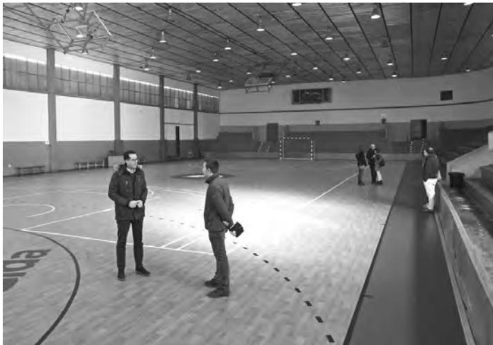
La pista mantiene el suelo de madera para no perder la amortiguación
