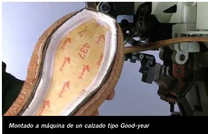
Montado a máquina de un calzado tipo Good-year
