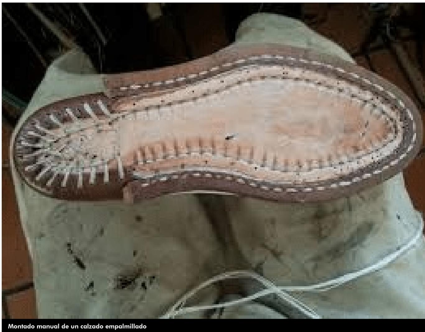
Montado manual de un calzado empalmillado
