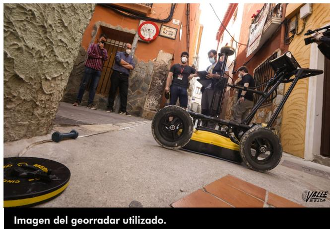
Imagen del georradar utilizado.
