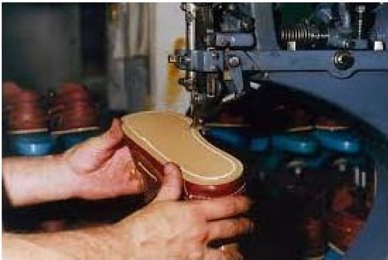
Punteado de calzado en un taller de terminado.
