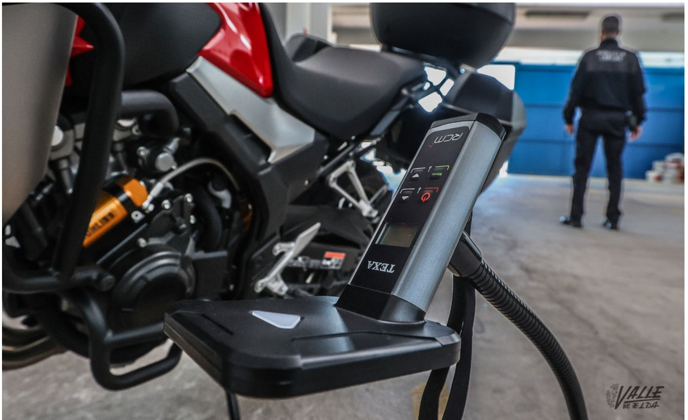
Imagen del aparato para detectar trucaje en motocicletas | J.C.
